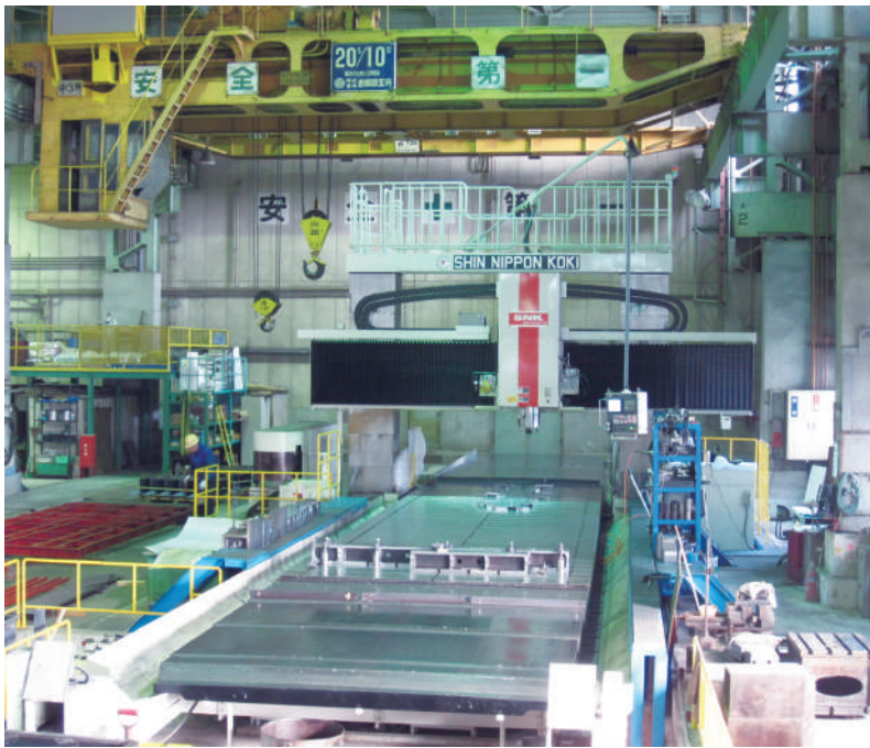
平成22年に導入した5面加工機（テーブル幅3m長さ10m）
