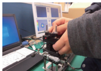
レーザー光の調整を専用の測定器を用いて調整する
