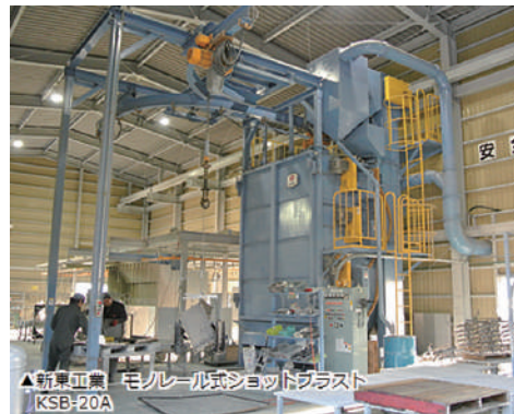
岡重工場_モノレール式ショットブラスト及び静電塗装ラインを導入し、ザビ止メ塗装まで一環生産が可能です
