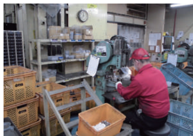
製造工程(リベット作業)の様子です。
