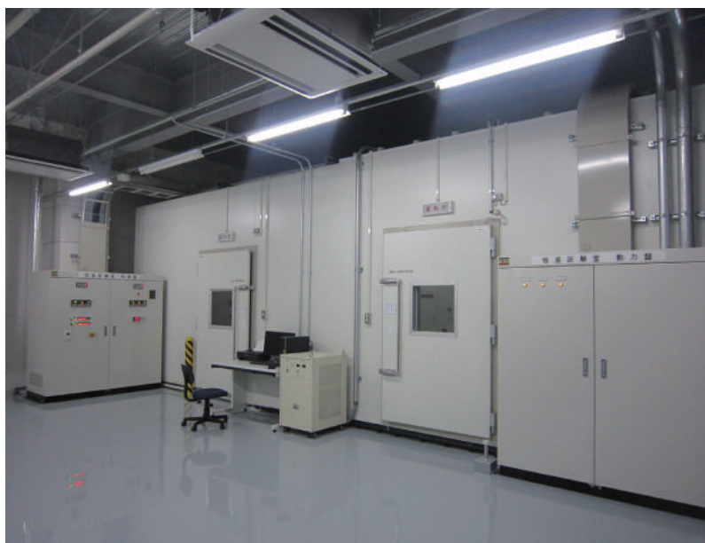
エアコン性能測定試験室
